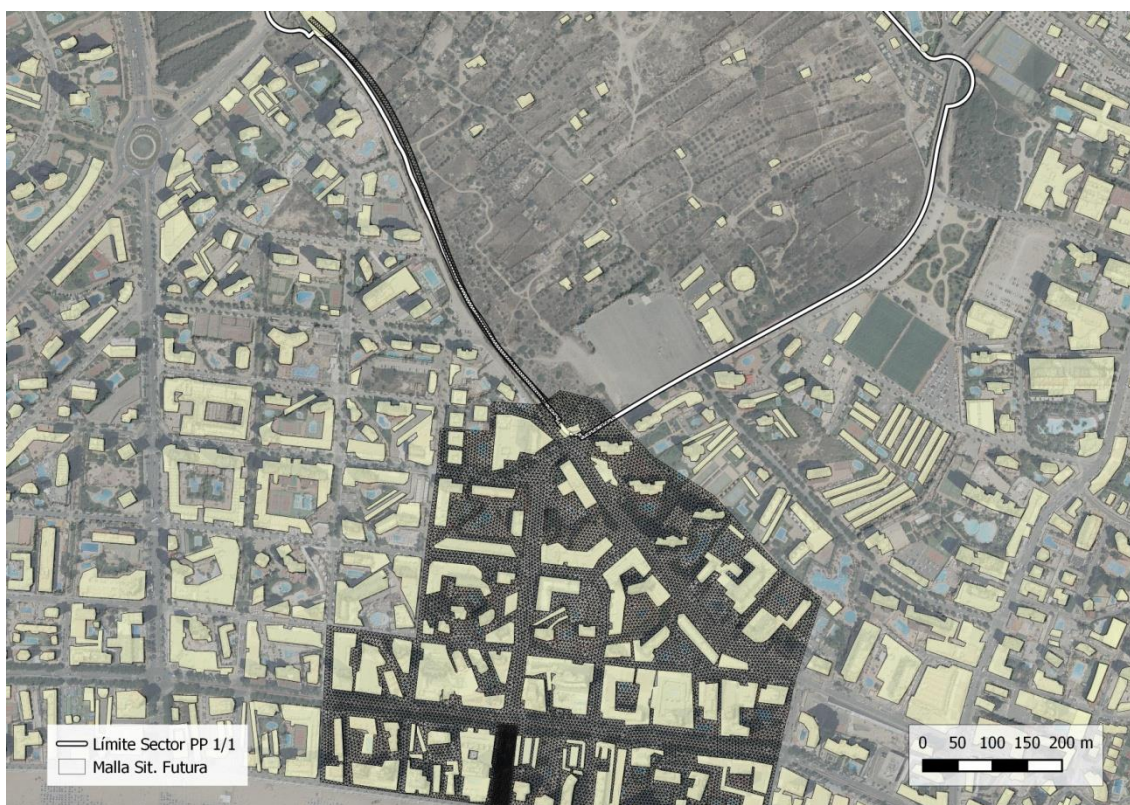
Malla del modelo hidráulico. Situación Futura
